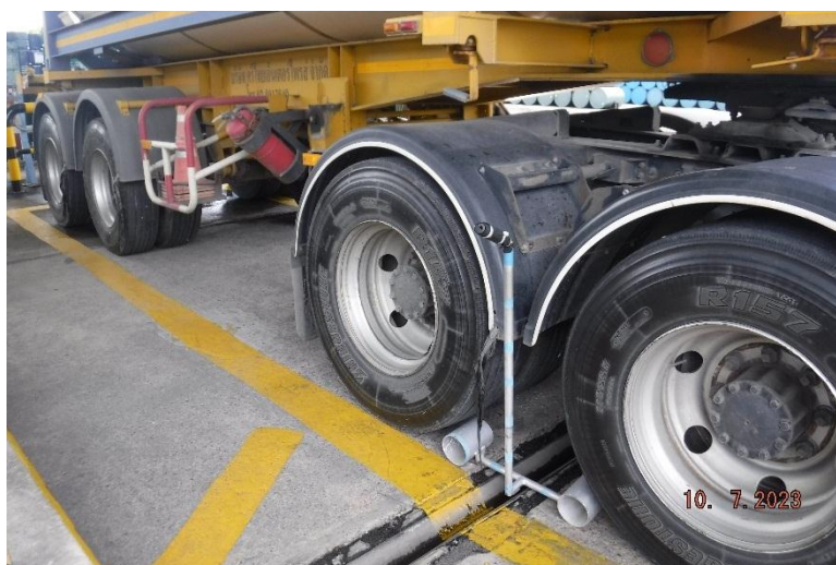
รูปที่ 2.2.2-4 การวางหมอนรองล้อ
